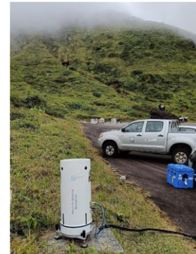
Figure : Gravimètre quantique absolu AQG#B01 sur La Soufrière de Guadeloupe - Crédits : G. Lion.
